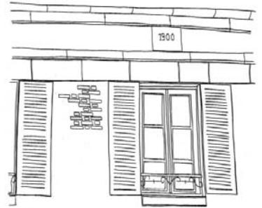
Les tableaux des fenêtres sont traités de la même façon que le mur de façade, simplement rejointoyés s'ils sont en brique ou en pierre de taille, enduits s'ils sont en moellon
